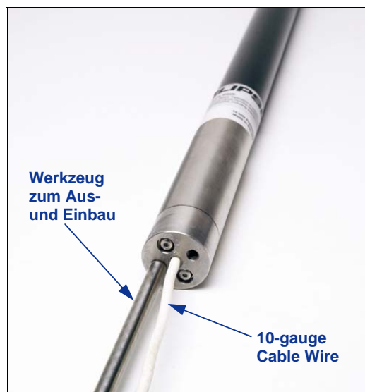
Kabelsender mit eingeschraubtem Werkzeug zum Aus- und Einbau
