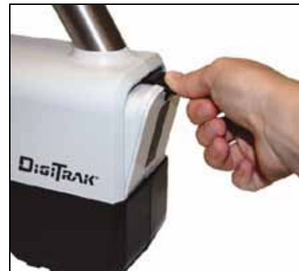
Remoção do pacote de baterias
