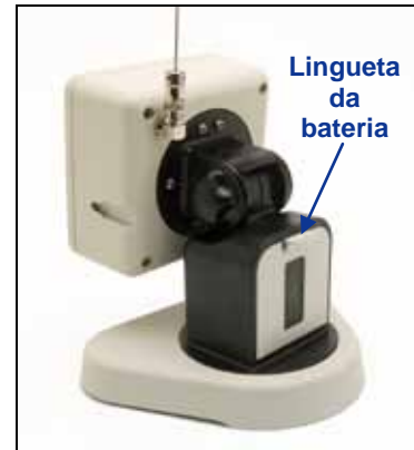
Remoto SED com Pacote de Baterias Instalado
